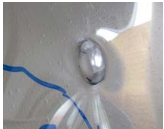
Figura 3. Tipica deformazione per impatto perfettamente perpendicolare alla lastra
