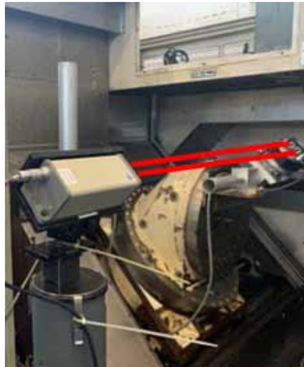
Macchina Huron con tavola rotante; misura della precisione di posizionamento angolare tramite interferometro.
