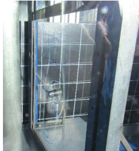
Figura 6. Limite di penetrazione balistica per polycarbonato di spessore 4mm (INAIL)
