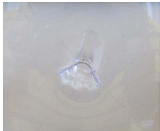
Figura 4. Tipica deformazione per impatto inclinato rispetto alla perpendicolare
