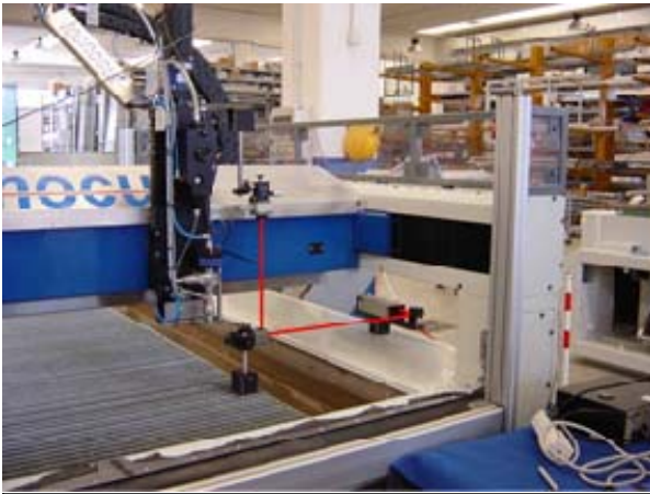
Fig.5 allineamento di squadra con la tecnica del pentaprisma in una macchina taglio ad acqua
