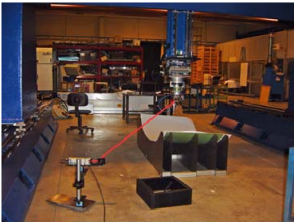
Fig.8 misura di precisione volumetrica diagonale in una macchina taglio laser per applicazioni aeronautiche
