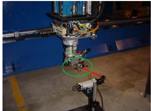
Fig.9 Laser ball-Bar ad alta velocità su macchina Taglio laser per applicazioni aeronautiche
