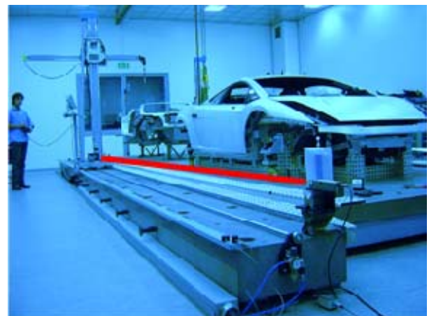
Fig.2 allineamento di rettilineità in una macchina di misura con interferometro a doppio raggio
